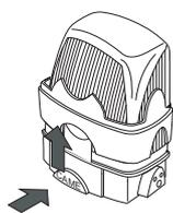
Для открывания корпуса сигнальной лампы надавить на защитную крышку и сдвинуть ее вверх
