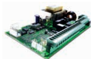
Плата управления блокиратора JE275 управление макс. 1 блокиратором J355 М30-Р1
