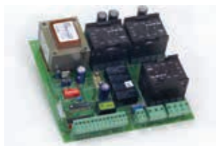
Плата управления 884 Т (встроена в привод)
