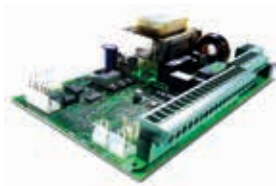
Плата управления 624 BLD (встроена в привод)
