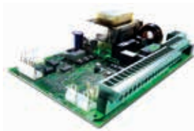
Плата управления 624 BLD (встроена в привод)
