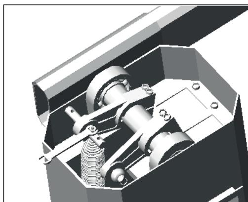
натяжение или ослабление балансирующих пружин шлагбаума. Если используется несколько пружин, то натягивать/ослаблять их нужно попеременно. При работе шлагбаума натяжение пружин должно быть равномерным.
