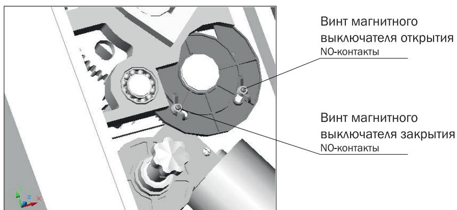
! Микровыключатели/герконы, включаемые в одну контрольную цепь и имеющие нормально-разомкнутые контакты, соединяются параллельно.
