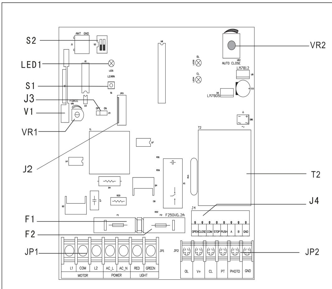
Перечень элементов модуля блока управления
