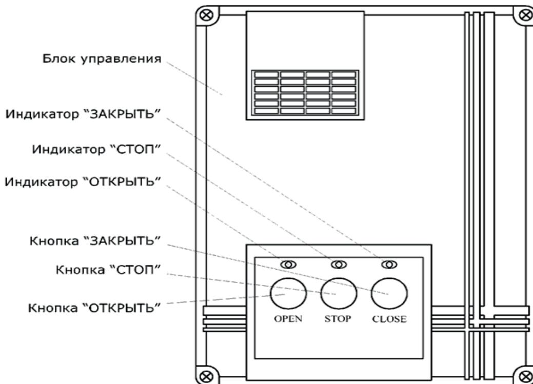
**Назначение элементов на панели блока управления**
