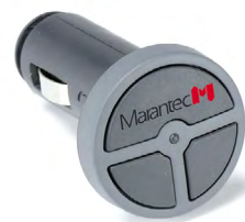
Digital 323 — трехканальный автомобильный пульт дистанционного управления
