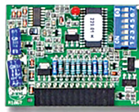
ZM SKS-B — модуль расширения функцио- нальных возможностей приводов STA со встроенным блоком управления
