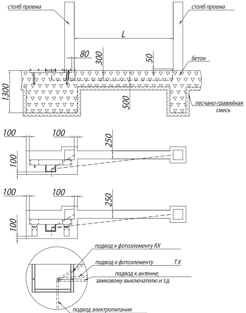
Рис. 76. Размеры фундамента и расположения опорной площадки под откатные ворота: ворота, изготовленные на базе «калиточных» профилей
