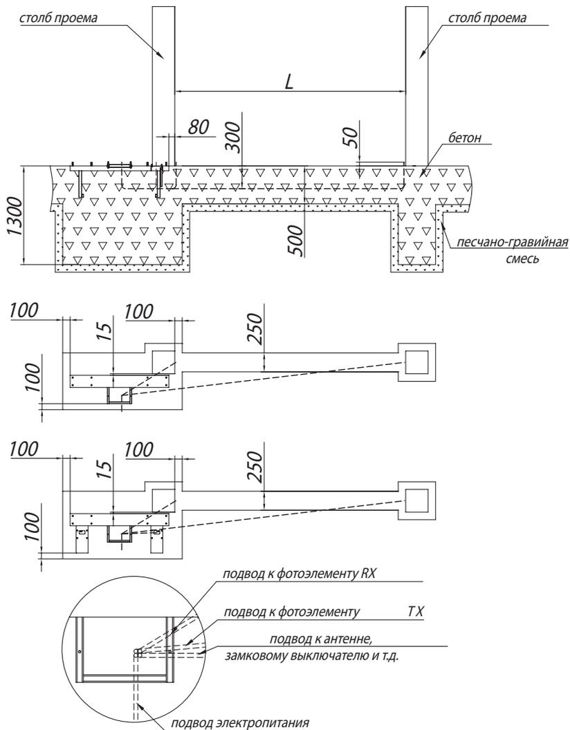
Рис. 7а. Размеры фундамента и расположения опорной площадки под откатные ворота: ворота, изготовленные на базе «стандартных» профилей
