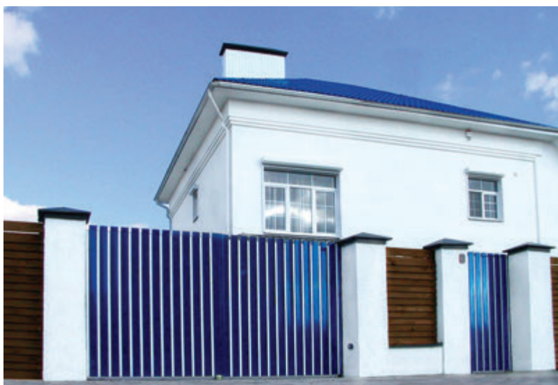
Сплошное заполнение алюминиевым профилем в виде гребенки
